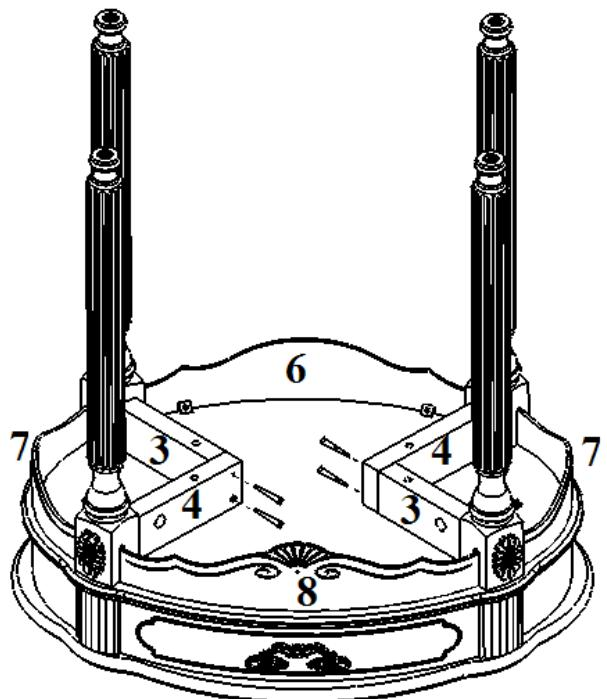
Детали №3 и №4 соедините саморезами 3,5x41 как показано на рис. 2.
