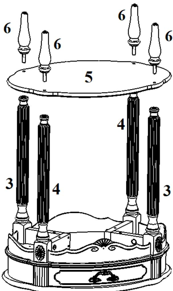
Вкрутите детали №6 в детали №3 и №4 через деталь №5 на шпильку-саморез до упора (не перетягивать!).
