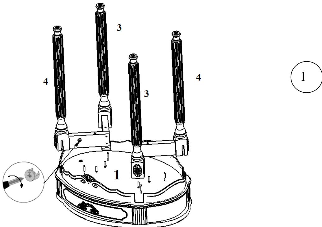
С внутренней стороны нижней столешницы детали №1 вставьте шканты в отверстия Ø8 мм и вкрутите штоки в отверстия Ø5 мм. В детали №3 и №4 вставьте эксцентрики. Установите детали №3 и №4, заверните в них эксцентрики до упора (рис 1).
