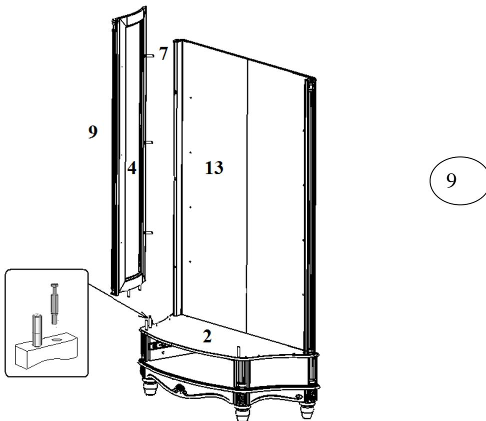
В деталь №4 вставьте шканты 8x30 в отверстия Ø8 мм. В деталь №2 вкрутите шток в отверстие Ø5 мм. Установите сборку из деталей №9, №4 на деталь №2 (рис.9). Слегка наклоняя сборку из деталей №9, №4 на себя соедините ее с деталью №7. В деталь №9 заверните эксцентрик до упора.
