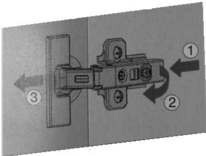
Демонтаж двери осуществляется наоборот, снизу вверх. В результате легкого нажатия пальцем на фиксаторную защелку (поз. 1), петля демонтируется. В ходе этой операции с монтажной планки снимается консоль петли (поз. 2), а дверь можно снять на себя (поз. 3).
