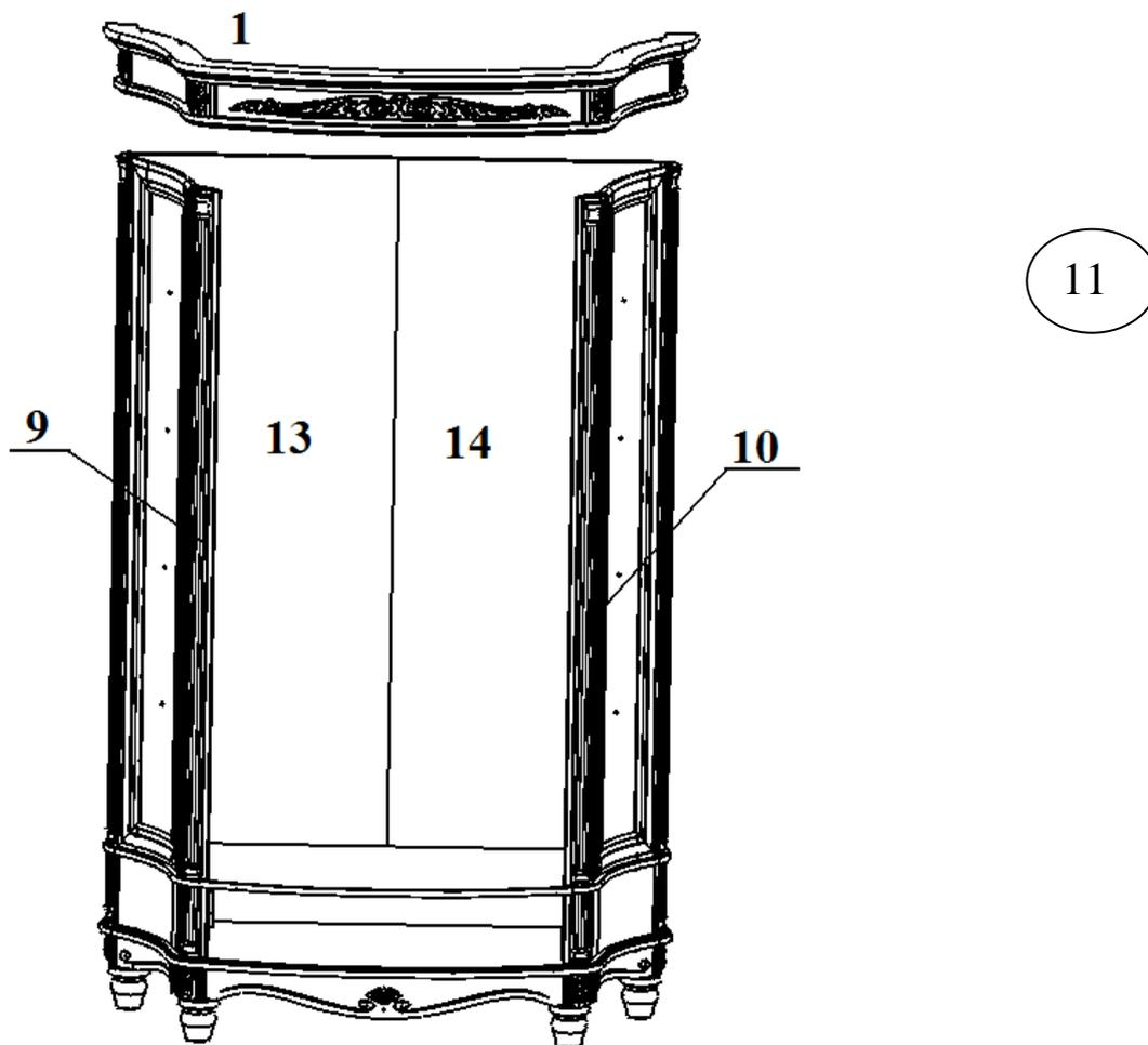
В деталь №1 вставьте шканты в отверстия Ø8 мм, вкрутите штоки в отверстия Ø5 мм. Установите деталь №1 на подсобранную конструкцию. В деталях №13, №14, №9, №10 заверните эксцентрики до упора. Места крепежа эксцентриков в деталях №9 и №10 необходимо закрыть самоклеящимися заглушками.
