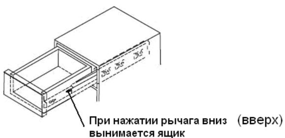
На внутренних стенках детали №2 установлены ответные части шариковых направляющих. Снимите шариковые направляющие, нажав рычаг вниз (рис. 1).
