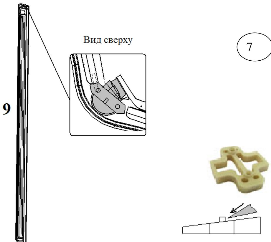
На детали №9, №10 прикрутите ответные планки петель Н=3 в комплекте с подкладкой 10° саморезами 3,5x19 согласно насечкам, предварительно срежьте с подкладки установочные втулки (рис 7).
