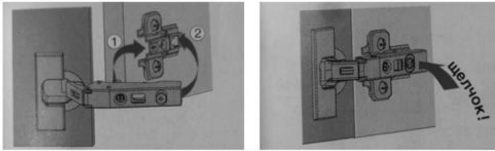
Процесс монтажа двери выполняется сверху вниз. Петля спереди накладывается на монтажную планку (поз.1), затем консоль петли защелкивается на монтажной планке (поз. 2) легким нажатием.
