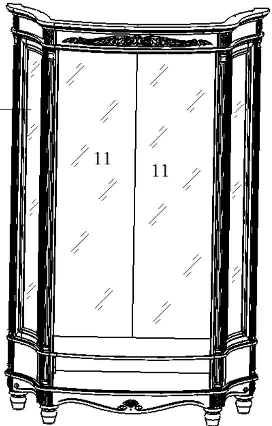
Зеркала №11 установите на детали №13 и №14. В отверстия деталей №11 вставьте соединённые между собой втулку 6мм и втулку пластиковую. Закрепите зеркала с помощью полкодержателей винтом М4х28 как показано на рис 12.
