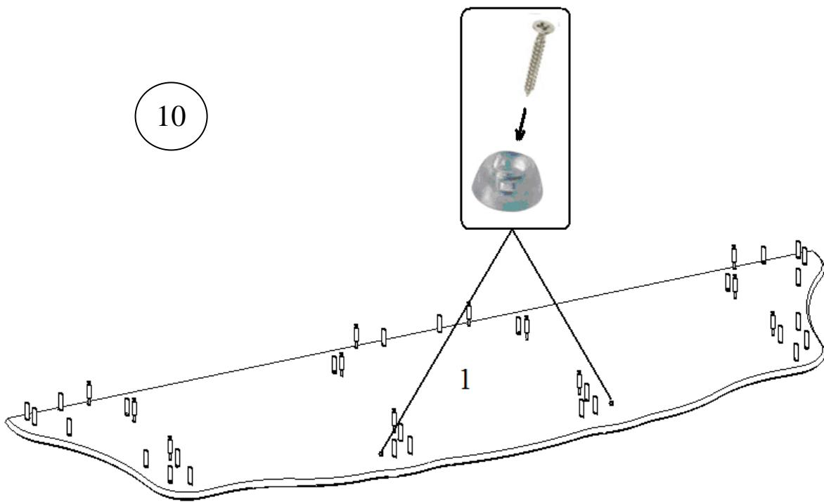
В деталь №1 вставьте шканты в отверстия Ø8мм и вкрутите штоки в отверстия Ø5мм (рис. 10). На деталь №1 закрепите демферы силиконовые саморезом 3,5x16 согласно насечкам.
