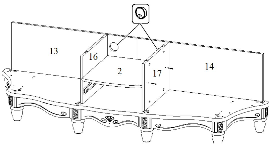
Установите деталь №2 на подсобранную конструкцию, соединив ее конфирматами с деталями №16 и №17. В деталь №17 заверните эксцентрики до упора. В детали №13 и №14 вставьте заглушки (рис.6).
