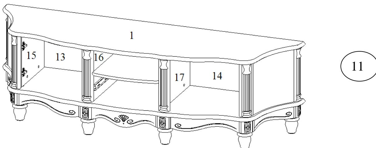
Установите деталь №1 на подсобранную конструкцию (рис 11). В детали №13, №14, №15, №16, №17 заверните эксцентрики до упора.
