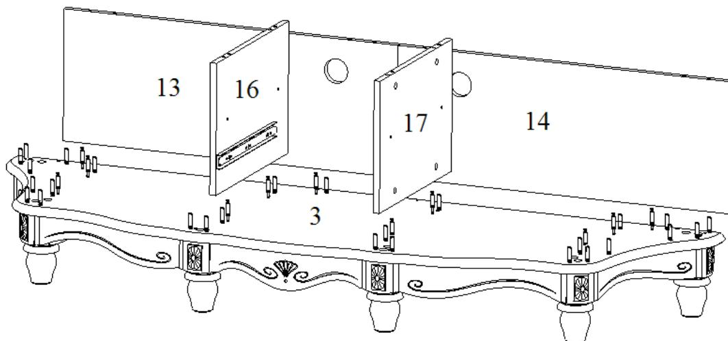
Вставьте в деталь №3 шканты в отверстия Ø8 мм и вкрутите штоки в отверстия Ø5мм. В детали №13, №14, №16, №17 вставьте эксцентрики. Установите детали №13, №14, №16, №17 на деталь №3 (рис 5). В детали №13, №14 и №16 заверните эксцентрики до упора (рис.5).
