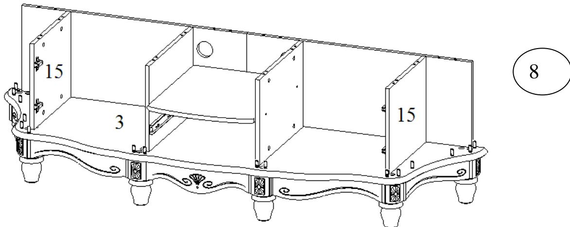
Вставьте в деталь №3 шканты в отверстия Ø8мм и вкрутите штоки в отверстия Ø5мм. В детали №15 вставьте эксцентрики. Установите детали №15 на деталь №3. В детали №15 заверните эксцентрики до упора (рис.8).
