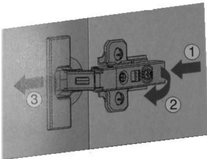
Демонтаж двери осуществляется наоборот, снизу вверх. В результате легкого нажатия пальцем на фиксаторную защелку (поз. 1), петля демонтируется. В ходе этой операции с монтажной планки снимается консоль петли (поз. 2), а дверь можно снять на себя (поз. 3).
