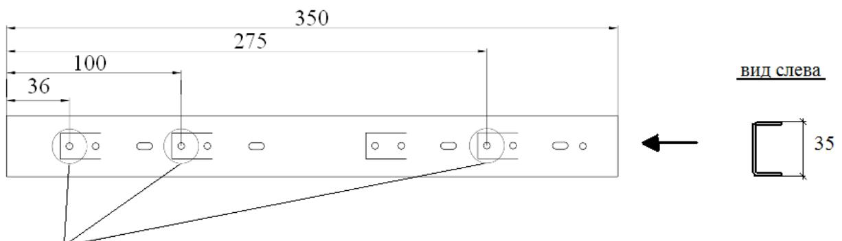
Монтажные отверстия, используемые для монтажа
