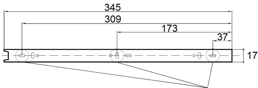
Монтажные отверстия, используемые для крепежа
