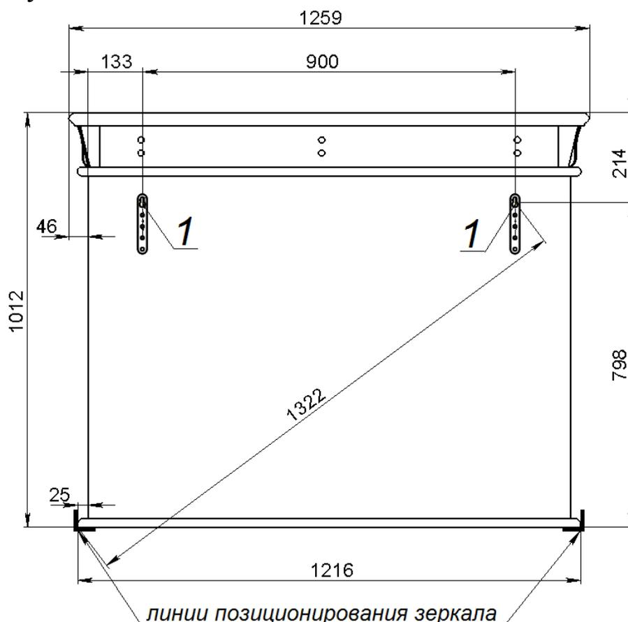
1 - отверстия для крепления зеркала
