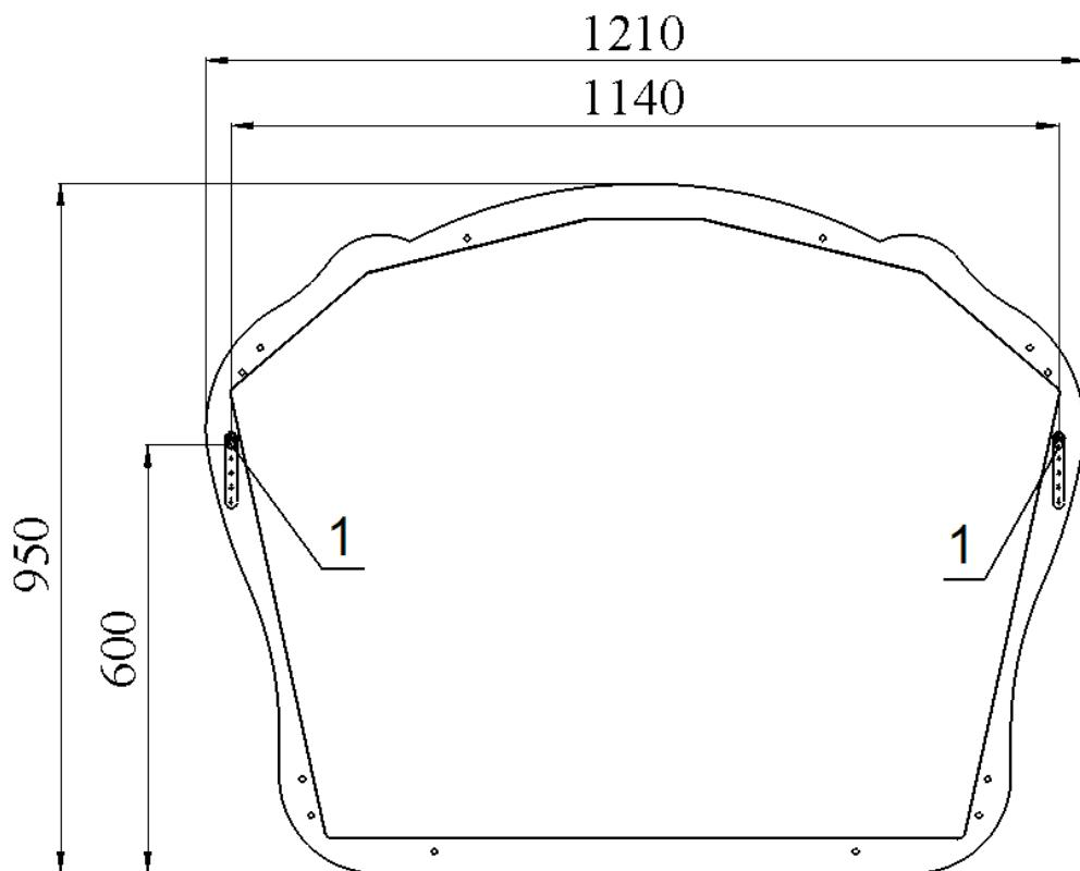
1 - отверстия для крепления зеркала
