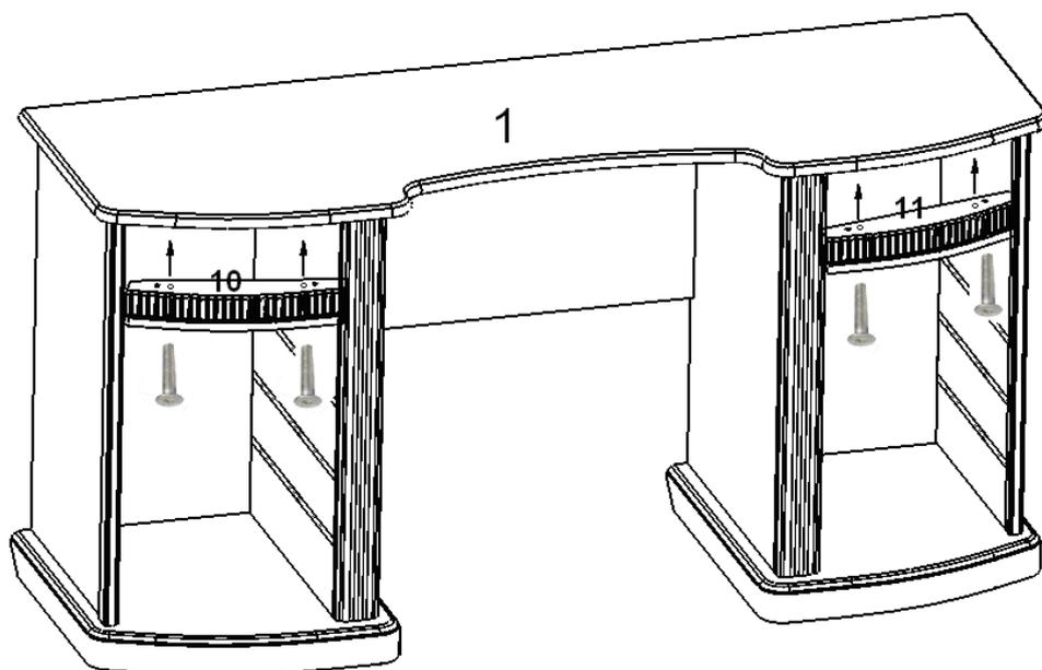
К столешнице №1 присоедините декоративные элементы №10 и №11 с помощью винтов М6х65 мм (рис. 10).
