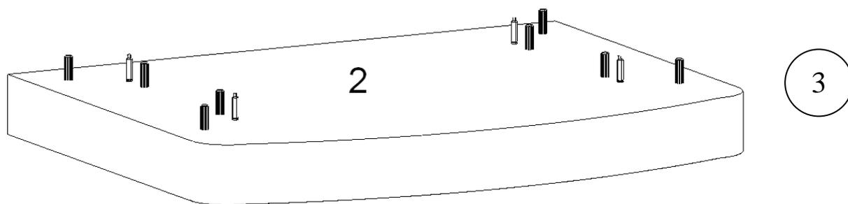
Вставьте в детали №2 и №3 шканты в отверстия Ø8 мм и вкрутите штоки в отверстия Ø5 мм (рис 3).
