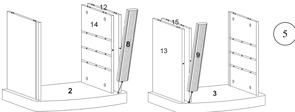
Вставьте в детали №14, №12, №13, №15 шкранты в отверстия Ø8 мм и присоедините детали №8 и №9 к подсобранным конструкциям, предварительно поставив в торцы этих деталей (№8 и №9) шкранты (рис 5).
