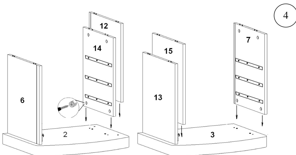
Соедините деталь №2 с деталями №6, №14 и №12. В детали №6, №14 заверните эксцентрики до упора. Соедините деталь №3 с деталями №7, №13 и №15. В детали №7 и №15 заверните эксцентрики до упора (рис.4).
