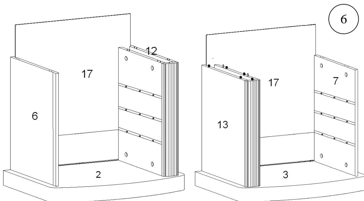
В пазы деталей №6, №12 и №2 вставьте заднюю стенку №17. В пазы деталей №7, №13 и №3 вставьте заднюю стенку №17 как показано на рис.6.
