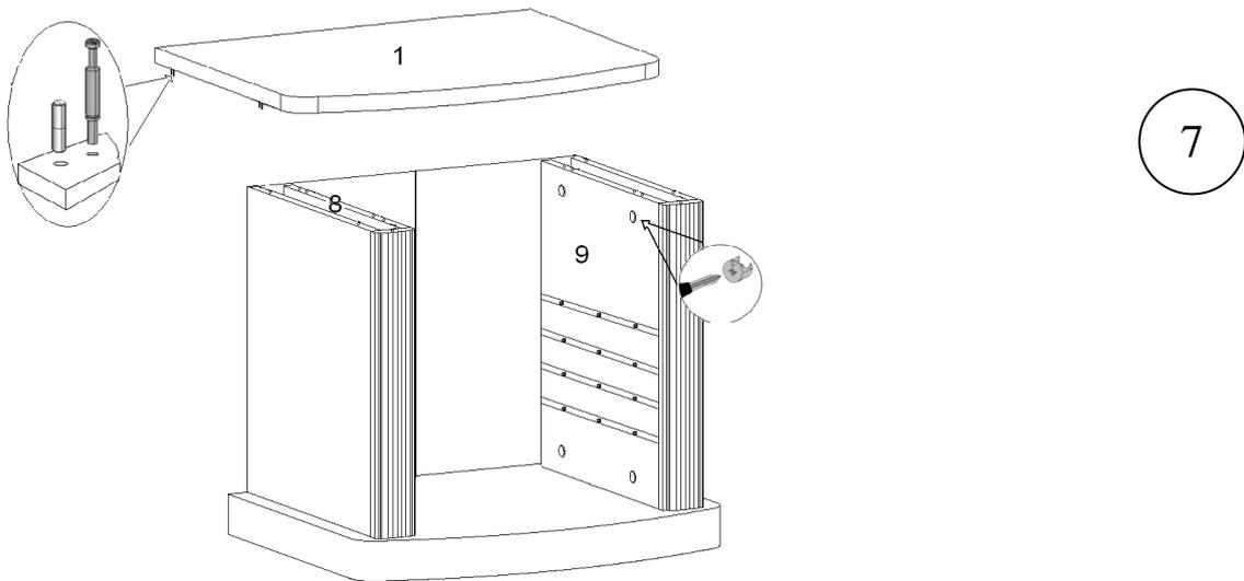
Вставьте шканты в отверстия  $\text{Ø}8$  мм и вкрутите штоки в отверстия  $\text{Ø}5$  мм на детали №1, установите ее. Заверните в детали №8 и №9 эксцентрики до упора как показано на рис.7.
