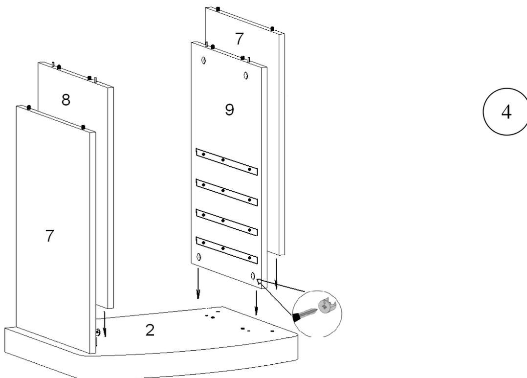
Соедините деталь №2 с деталями №7, №8 и №9. В детали №8 и №9 заверните эксцентрики до упора (рис.4).
