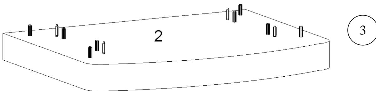
Вставьте в деталь №2 шканты в отверстия  $\text{Ø}8$  мм и вкрутите штоки в отверстия  $\text{Ø}5$  мм (рис 3).
