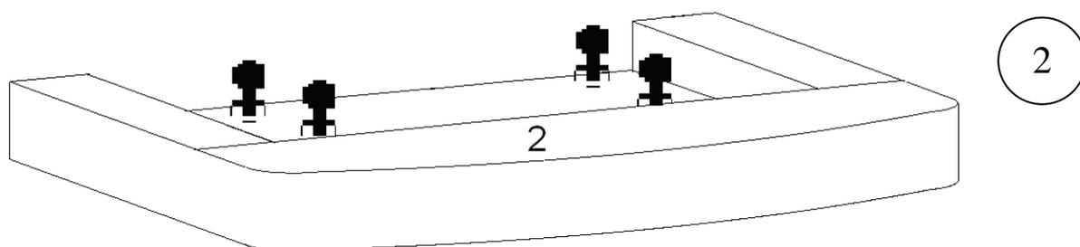
Вставьте в деталь №2 с внутренней стороны в сквозные отверстия  $\text{Ø}10$  мм опоры регулируемые, как показано на рис.2.
