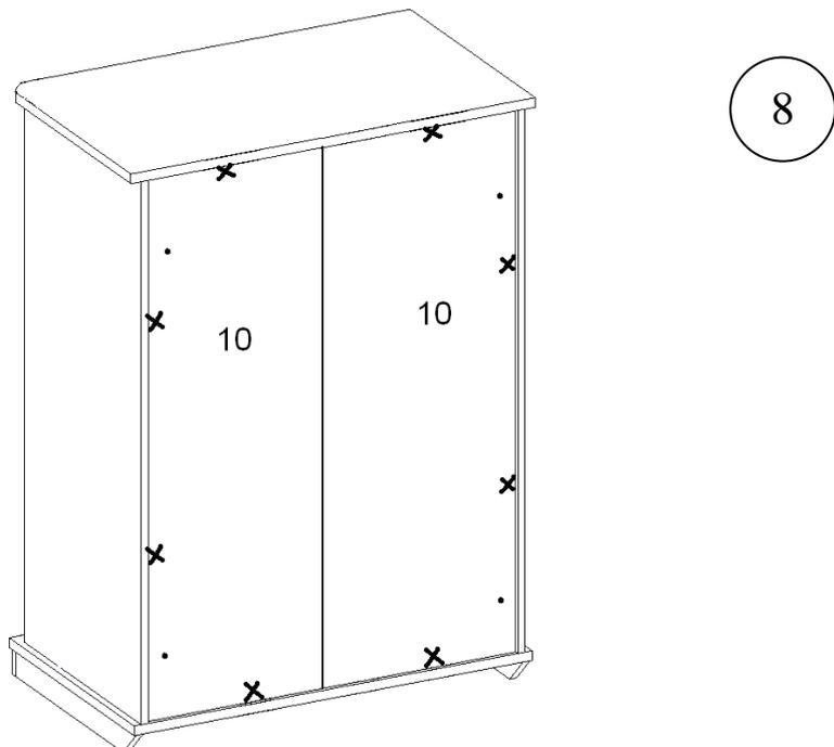
**Внимание!** Настоятельно рекомендуем выставить изделие строго в уровень к горизонту с помощью регулируемых опор на месте постоянной эксплуатации изделия. После этого проверить диагональ изделия. Установите уголок мебельный с саморезом для фиксации задних стенок №10 в местах, отмеченных знаком **ж**. Прибейте гвоздями детали №10 к деталям №8 и №9 (рис.8).
