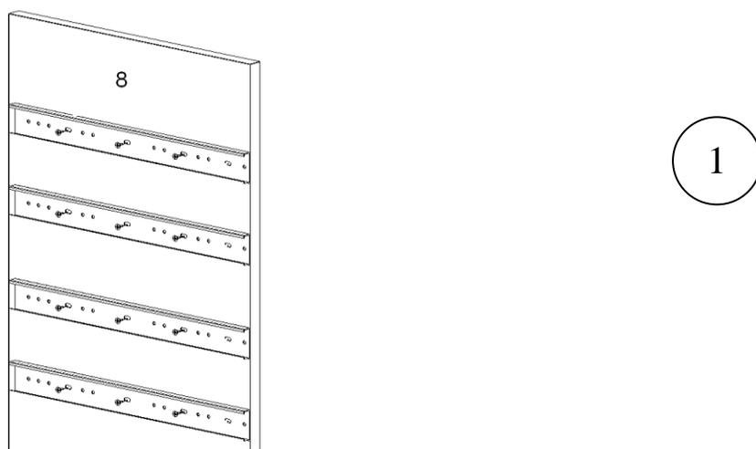
Прикрутить ответные части шариковых направляющих на детали №8 и №9 (рис.1) согласно насечкам заподлицо с передней кромкой боковины в 3 отверстия с помощью саморезов 3,5x16.
