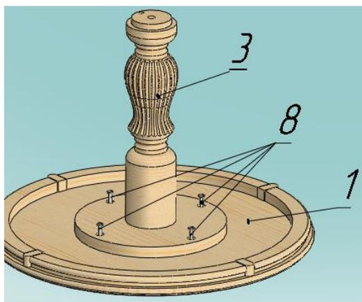
3. Соедините основание ноги (4) и основание нижнее (5) с ногой через шкант установленный в ногу (3) и закрепите шурупом (6), подложив шайбу (7) Рис.3.
